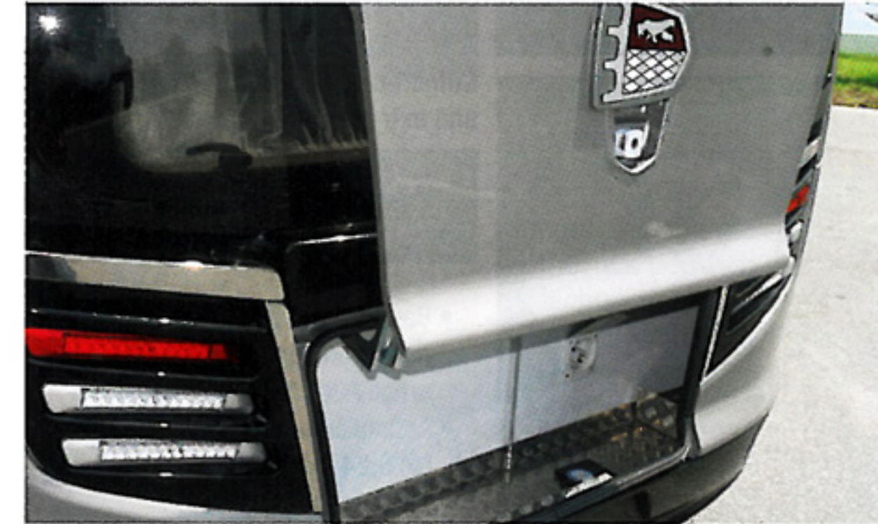
Das Heckfach fasst eine Menge Gepäck und enthält unsichtbare Wasser- und Stromanschlüsse. Kabel und Leitung laufen durch Luken im Boden.
